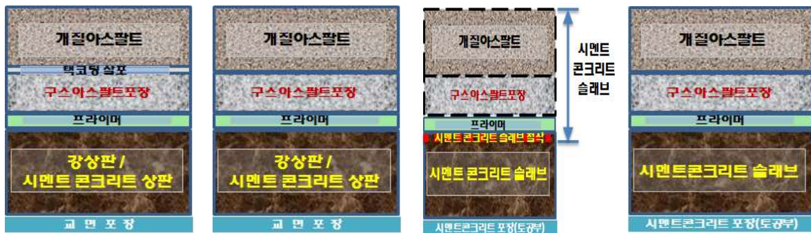
절삭 후 오버레이 구스 아스팔트 시멘트 포장 오버레이(Over lay)
